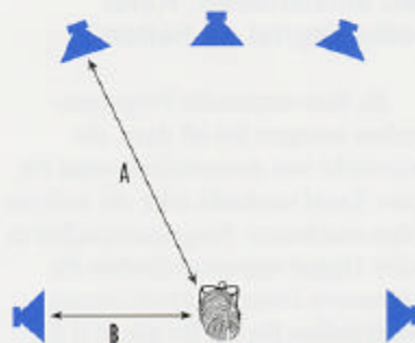
Abbildung 8: Die Entfernungen A und B dienen zur Berechnung der Surround-Verzögerungszeit mit Hilfe eines der beiden Diagramme rechts. Die Einstellung in einer der Betriebsarten sorgt automatisch für den richtigen Wert in der anderen.
